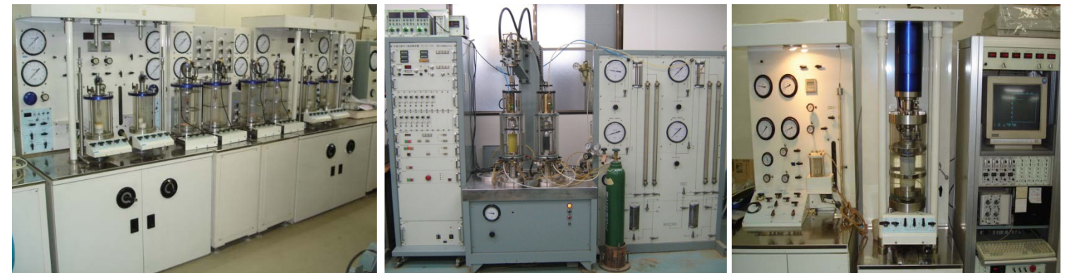
三軸圧縮試験装置 繰り返し三軸圧縮試験装置 中空ねじりせん断試験装置
